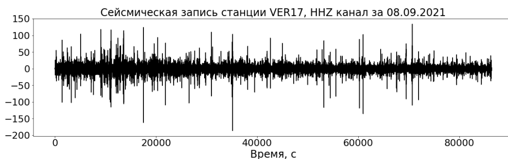
Рисунок 4. – Пример сейсмической записи с временной станции VER17 за 08.09.2021 после временной нормализации сглаженной огибающей.
