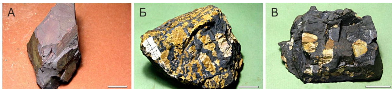
Рисунок 3.4. Основные разновидности руд месторождения Поперечное: А – массивная гематитовая; Б – железо-марганцевая; В – богатая марганцевая. Линейка 2 см.
