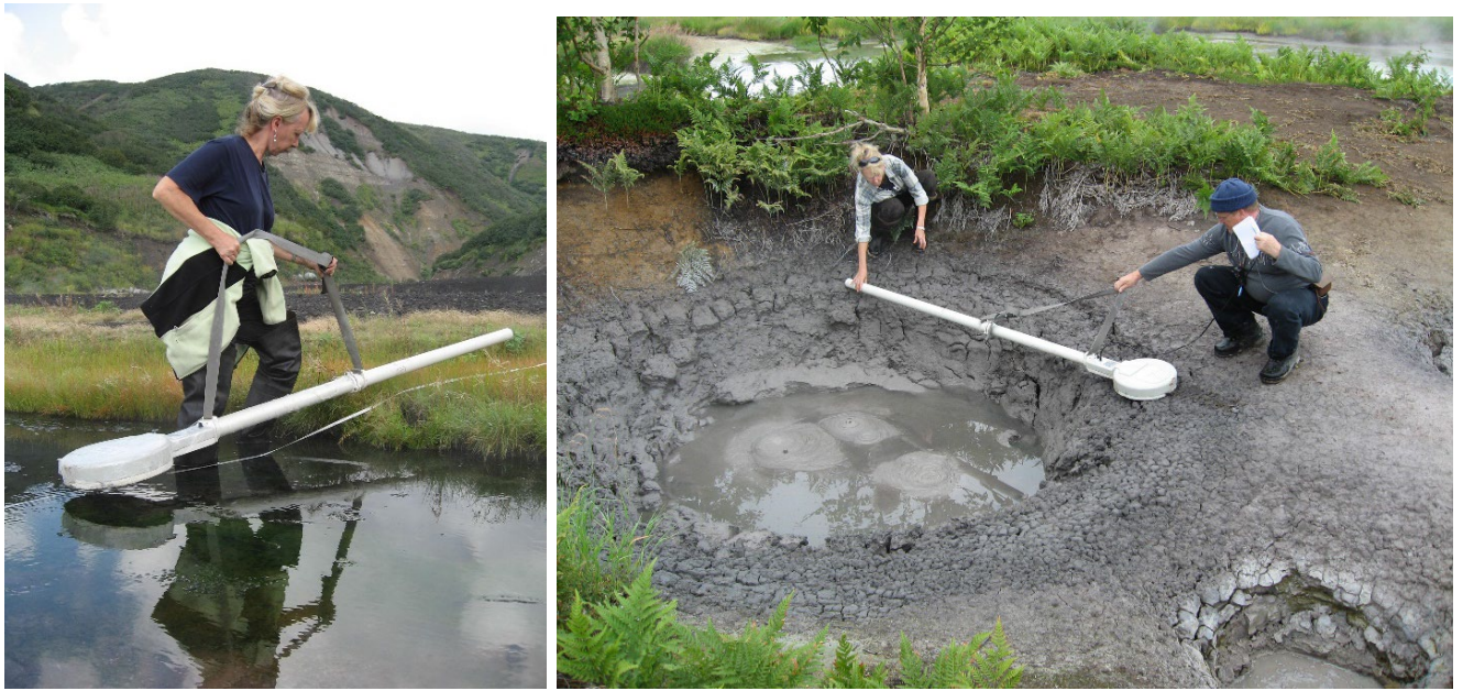
Рисунок 3.1 - С.Б. Бортникова и А.К. Манштейн выполняют исследования на ручье Горячем кальдеры Академии Наук (слева) и над кипящим котлом кальдеры Узон (справа) прибором ЭМС
