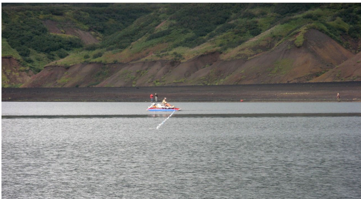
Рисунок 3.9 - Плавающая установка электротомографии на акватории, в лодке – Г.Л. Панин, фото С.Б. Бортниковой
