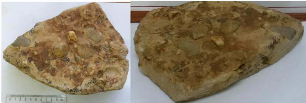
Рис. 4.4.3. Рассеянный по поверхности напластования грубообломочный материал в толще 2. Месторождение Южная Рассольная
