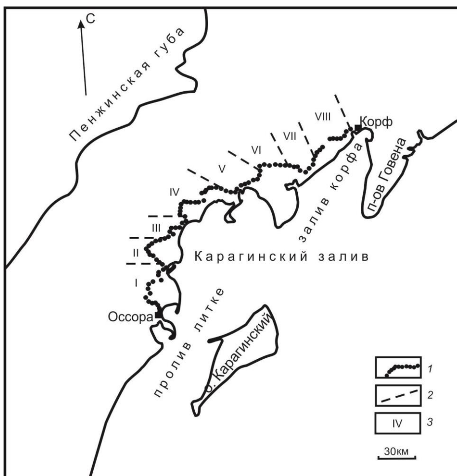
Рис. 3.5. Схема расположения районов профиля «Северный», для которых получены средние продольные и поперечные кривые МТЗ: 1 – пункты МТЗ; 2 – границы районов; 3 – номера районов.
