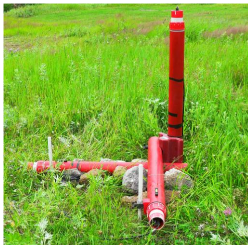
Рис. 2.2. Установка индукционных датчиков в условиях каменистой местности.
