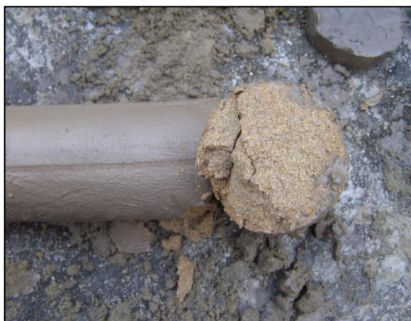
Рисунок 4.8. Образец слоя 18 (мелко- и тонкозернистые пески, коричневые, желтовато-коричневые) взят из скважины QT1 с глубины 22,8 – 23,0 м по объекту № 84 улицы Чуаланг микрорайона Лангтхьонг района Донгда города Ханоя [96]
