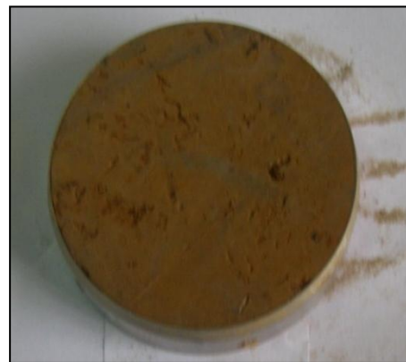
Рисунок 4.3. Образец слоя 6 (суглинок, желтовато-серый, коричневый, тугопластичный) из скважины QT1 с глубины 2,8 – 3,0 м по объекту № 84 улицы Чуаланг города Ханоя [96]
