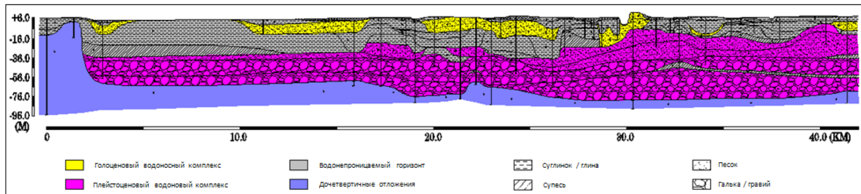
Рисунок 3.7. Распространение и мощность голоценового водоносного и плейстоценового комплекса в гидрогеологическом разрезе по линии II-II' (Фи Х.Т., 2013)
