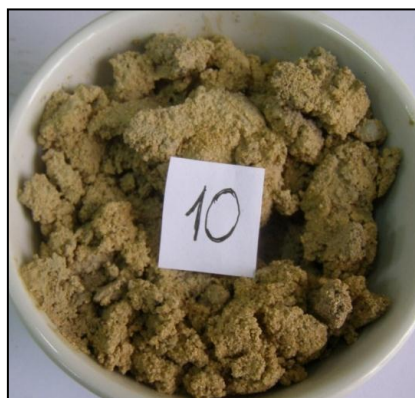
Рисунок 4.9. Образец слоя 19 (средне- и крупнозернистые пески, местами с гравием и галькой, желтовато-серые) взят из скважины QT1 с глубины 26,5 – 27,0 м по объекту № 84 улицы Чуаланг микрорайона Лангтхьонг района Донгда города Ханоя [96]
