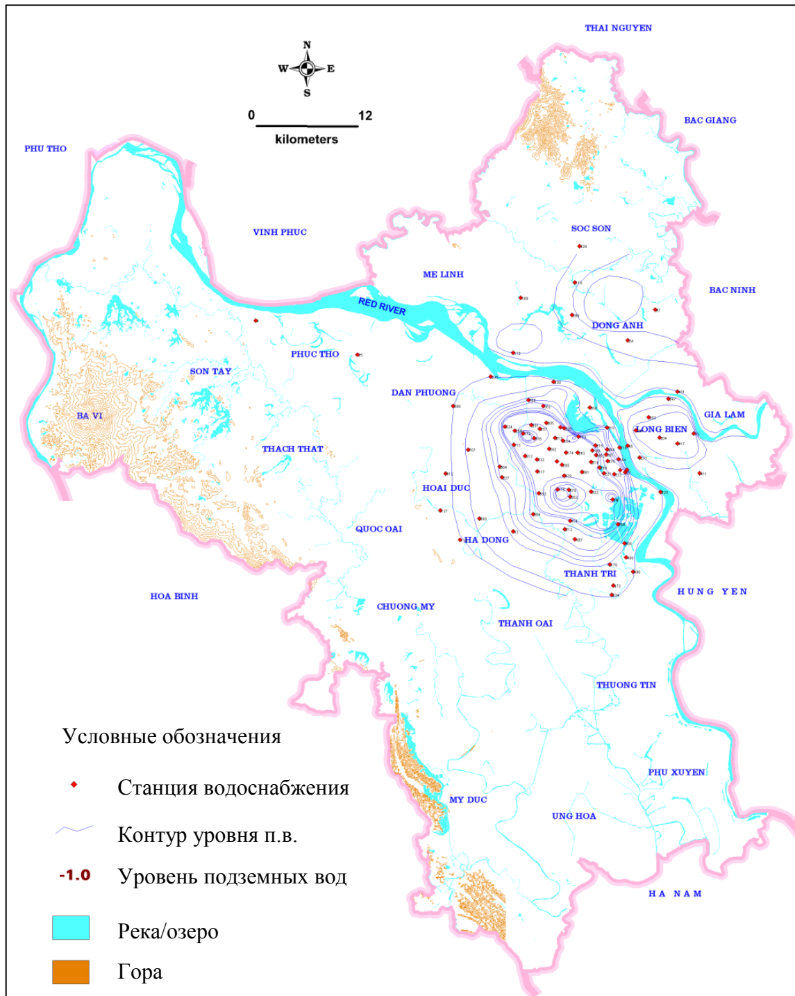
Рис. 6.8. Пункты для расчета оседания на карте уровня подземных вод плейстоценового комплекса на территории г. Ханоя в 2030 г. (Фи Х.Т., 2013)
