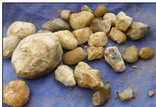
Рисунок 4.11. Гравийно-галечниковые отложения из скважины QT1 с глубины 45,0 – 48,0 м по объекту № 84 улицы Чуаланг микрорайона Лангтхыонг района Донгда города Ханоя [96]
