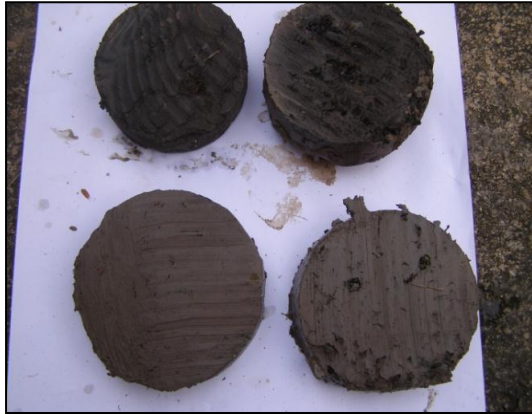
Рисунок 4.5. Образцы слоя 13 (суглинистый ил с органическими остатками) взяты из скважины QT1 с глубины 10,6 – 10,8 м и 16,3 – 16,5 м по объекту № 84 улицы Чуаланг микрорайона Лангтхьонг города Ханоя [96]
