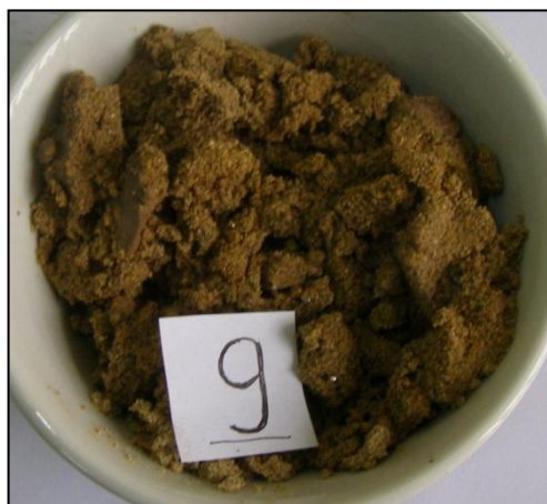
Рисунок 4.8. Образец слоя 18 (мелко- и тонкозернистые пески, коричневые, желтовато-коричневые) взят из скважины QT1 с глубины 22,8 – 23,0 м по объекту № 84 улицы Чуаланг микрорайона Лангтхьонг района Донгда города Ханоя [96]
