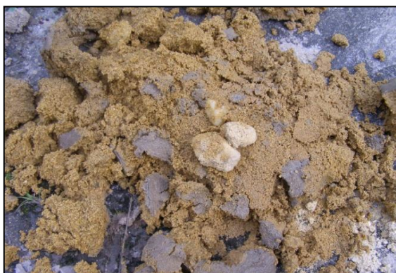
Рисунок 4.9. Образец слоя 19 (средне- и крупнозернистые пески, местами с гравием и галькой, желтовато-серые) взят из скважины QT1 с глубины 26,5 – 27,0 м по объекту № 84 улицы Чуаланг микрорайона Лангтхьонг района Донгда города Ханоя [96]
