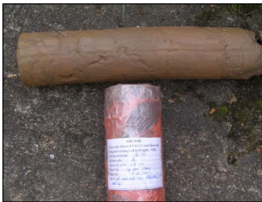
Рисунок 4.3. Образец слоя 6 (суглинок, желтовато-серый, коричневый, тугопластичный) из скважины QT1 с глубины 2,8 – 3,0 м по объекту № 84 улицы Чуаланг города Ханоя [96]
