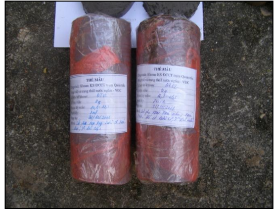
Рисунок 4.5. Образцы слоя 13 (суглинистый ил с органическими остатками) взяты из скважины QT1 с глубины 10,6 – 10,8 м и 16,3 – 16,5 м по объекту № 84 улицы Чуаланг микрорайона Лангтхьонг города Ханоя [96]
