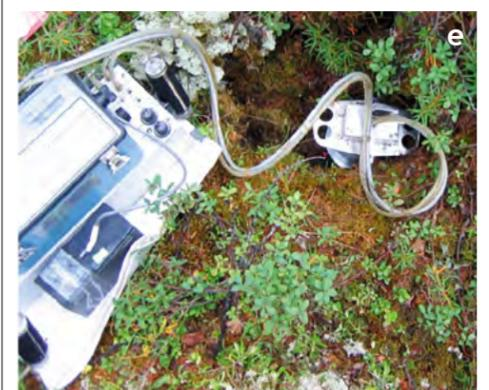
Определение почвенного дыхания при помощи ИК-газоанализатора и почвенной камеры в лиственничниках Эвенкии
