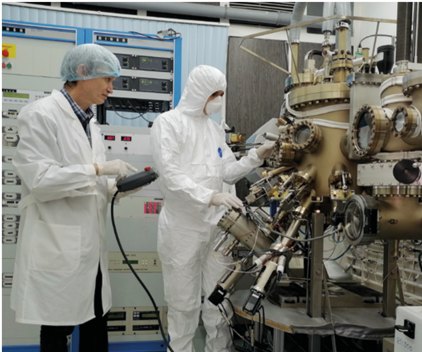
Старший научный сотрудник кандидат физико-математических наук А. К. Бакаров (слева) обучает аспиранта М. А. Суханова работе на установке молекулярно-лучевой эпитаксии полупроводниковых материалов на основе соединений A^3B^5
