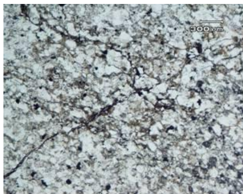
Рис. 1. Обр.1С-9.0 м. Метапесчаник, текстура микрослоистая, структура псаммитовая; признаки бластогенеза: глинисто-сланцевый цемент превратился в мусковит, биотит и хлорит, трещина заполнена гранобластами эпидота, кальцита и кварца; признаки катаклаза: микротрещины с агрегатным эпидотом и чешуйками биотита; R_{пр}=2.74 ; R_p=30.6 ; R=132.3 ; K_{ан}(R/R_p)=4.3 ; K_{рА} , K_{рБ}=0.61–0.67 .
