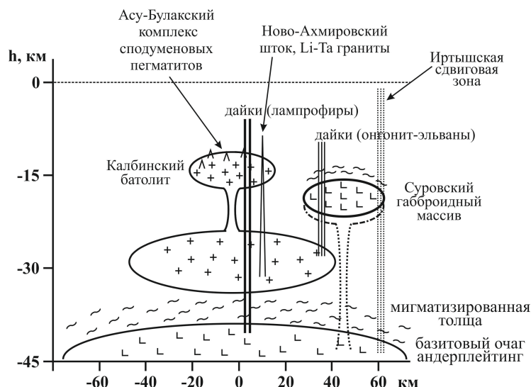
Рис. 2. Конфигурация редкометалльной рудно-магматической системы Калба-Нарымского пояса, принятая для численного моделирования.
