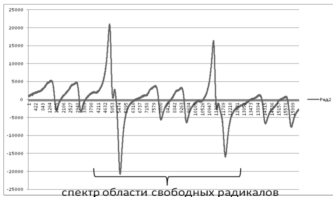
Рис. 3. Спектр образца в области свободных радикалов, отожженной до 600 °С.
