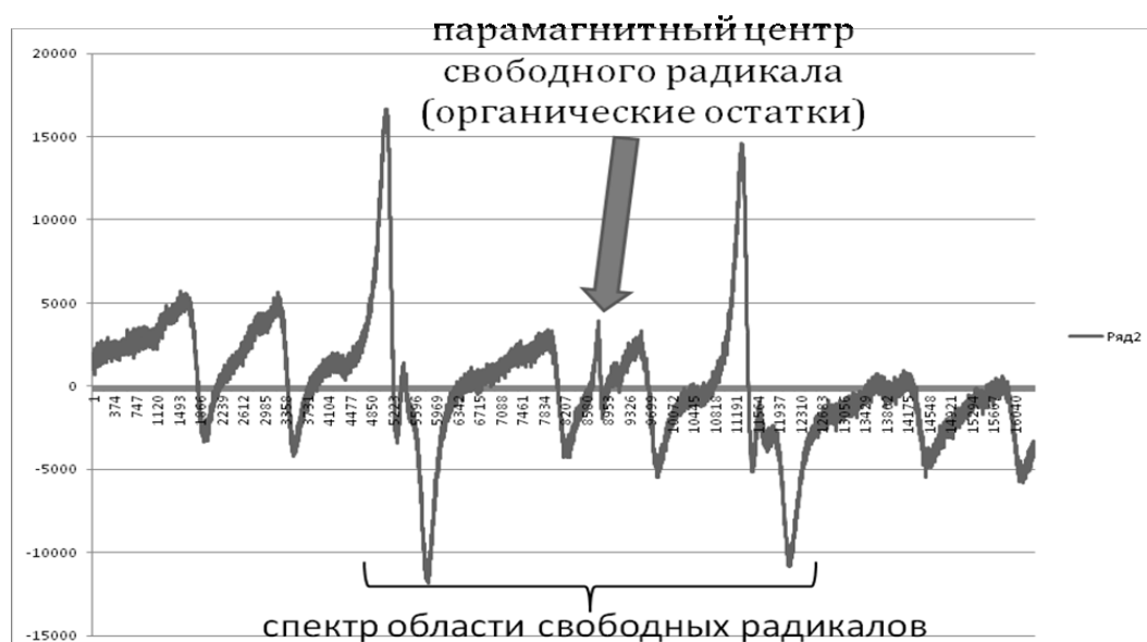
Рис. 2. Спектр пробы в области свободных радикалов, отожженной при t=350 °С.
